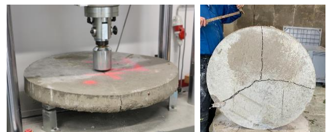
Abb. 3 Test des Energieabsorptionsvermögens an RDP Platten
