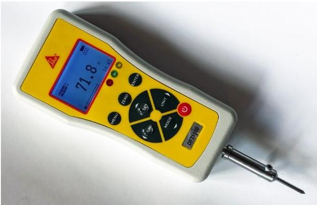
Abb. 2 Digitales Kraftmessgerät für die Nadelpenetrationsmethode.
