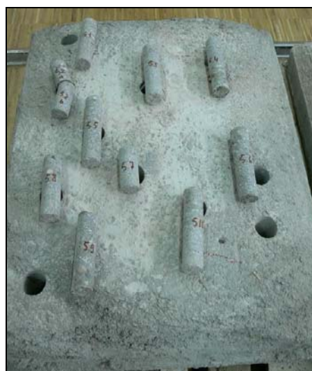
Bild 2: Entnahme von Probekörpern aus einer Verbundplatte
