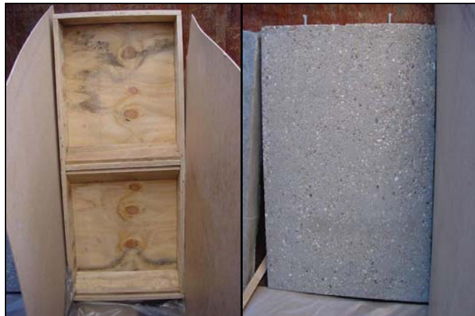
Bild 1: Spritzkiste (links) und Betonplatte für Verbundplatte (rechts)
