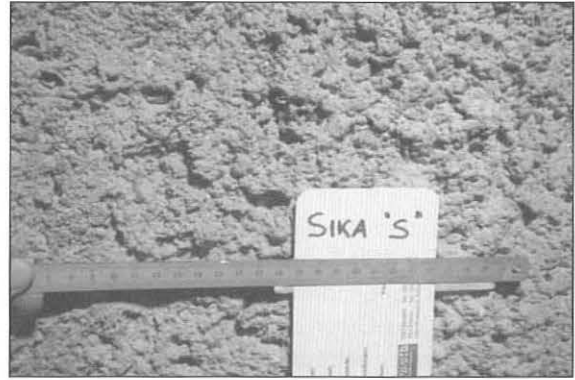
Bild 7: Spritzbetonplatten Sika S
