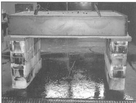
Bild 8: Vornässung eines Probekörpers zur Simulation durchnässter Tunnelbereiche
