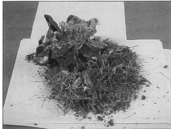
Bild 11: Nicht aufgelöster Microsilica Sack im Spritzbeton
