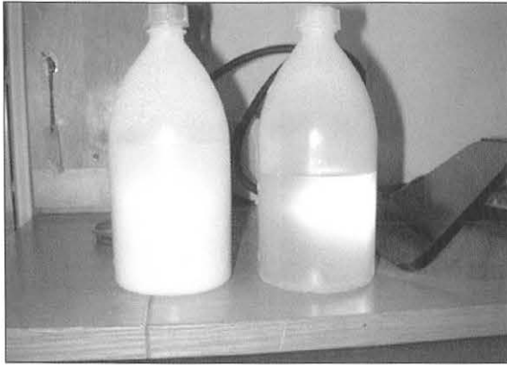
Bild 7: Auskristallisierter (links) und lagerstabiler Beschleuniger (rechts)
