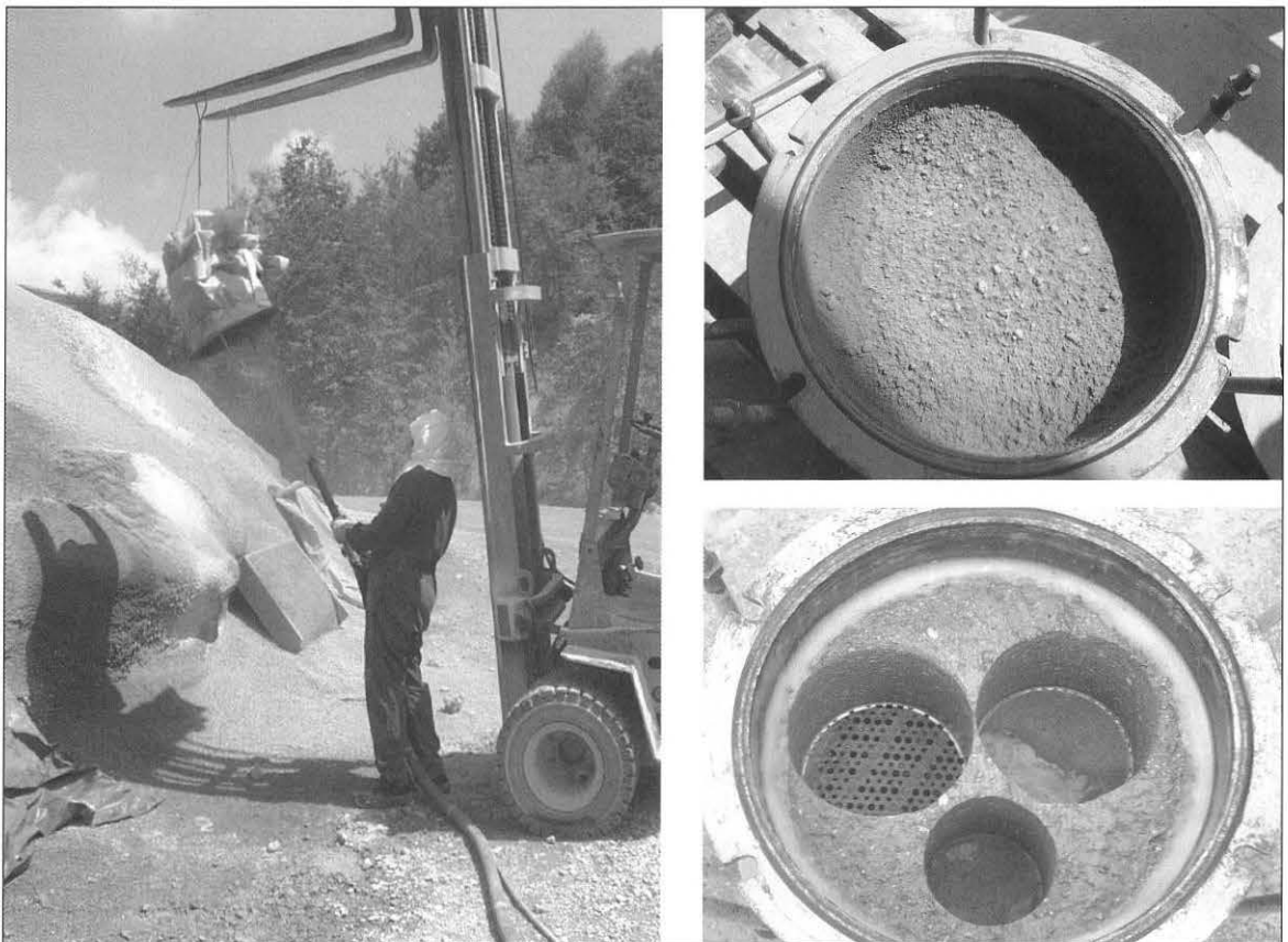
Bild 3: Spritzbetonversuche zur Luftdurchlässigkeitsmessung unter Druckluft
