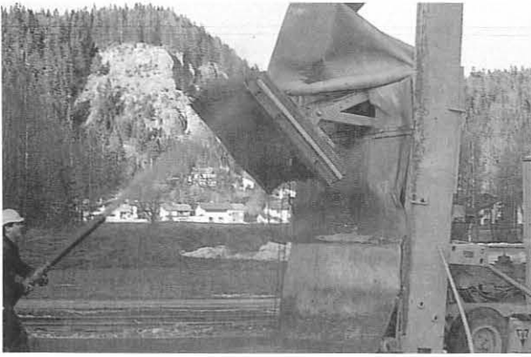
Bild 6: Versuchsspritzstand zum Vertikal- und Überkopfspritzen.
