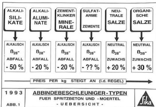
Bild 1: Übersicht: Abbindebeschleuniger - Typen für Spritzbeton und -Mörtel
