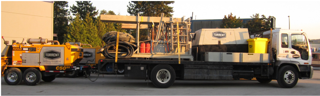
Bild 2: Typisches Einsatzfahrzeug mit Kompressor, Pumpe and Arbeitsbühnen (Bild: Torrent)
